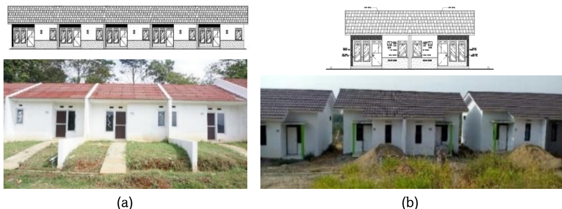
Gambar 7. Konfigurasi Seri (a) dan Kopel (b) pada Rumah Khusus dan Rumah Subsidi
