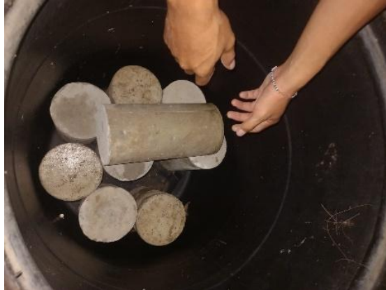
Gambar 2. Proses perendaman air laut
