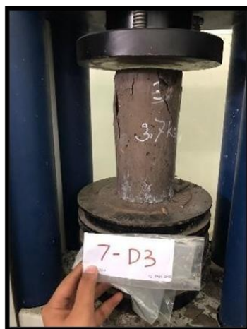
Gambar 2. Pengujian kuat tekan beton geopolimer
