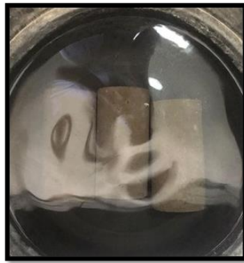
Gambar 3. Proses metode perawatan beton geopolimer dengan metode pembasahan
