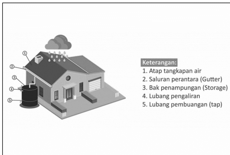
Gambar 2. Ilustrasi desain pengumpul air hujan yang signifikan (Penulis, 2023)
