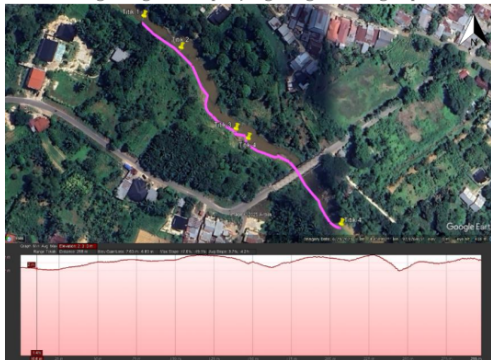
Gambar 2. Penentuan penempatan geobag di Krueng Langsa Sumber: Google Earth
