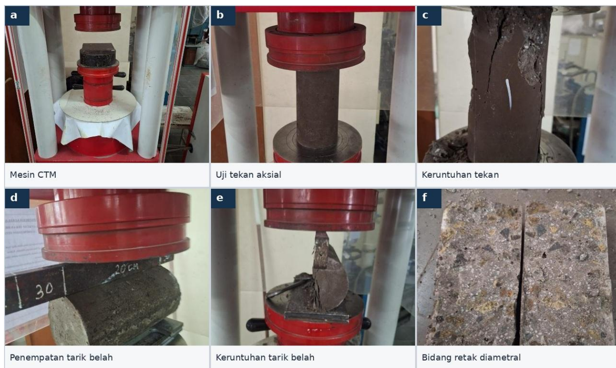
Gambar 7. Dokumentasi pengujian dan pola keruntuhan: (a) CTM; (b) uji tekan; (c) keruntuhan tekan; (d) penempatan tarik belah; (e) keruntuhan tarik belah; dan (f) bidang retak diametral
