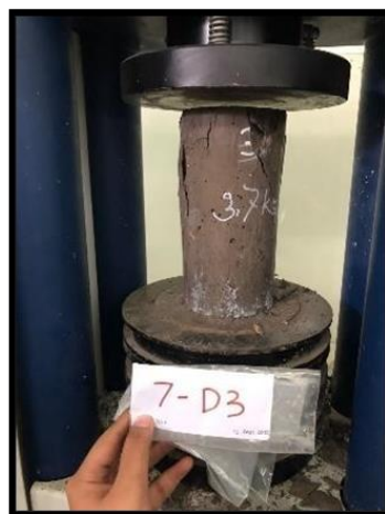
Gambar 2. Pengujian kuat tekan beton geopolimer
