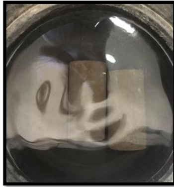
Gambar 3. Proses metode perawatan beton geopolimer dengan metode pembasahan
