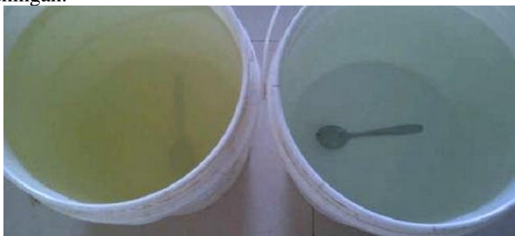
Gambar 2. Perbedaan air yang belum diolah dengan tawas dan yang telah diolah dengan tawas.
