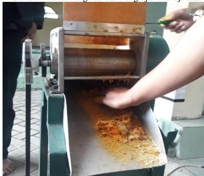
Gambar 5. Produk hasil Mesin Pamarut berbasis tenaga listrik
