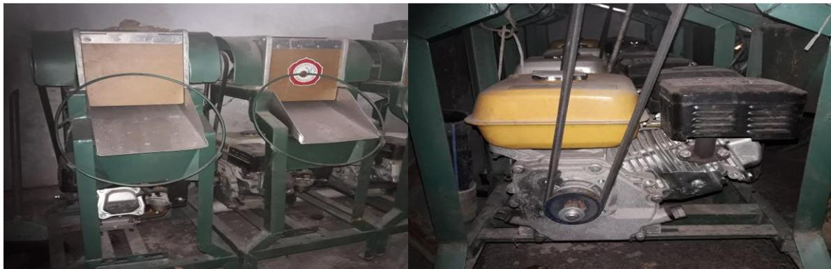
Gambar 2. Kondisi existing mesin produksi pamarut bahan baku
