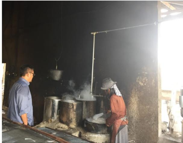
Gambar 4. Sistem pemanas *steam* dan pemasakan soun secara manual pada UKM di tahun sebelumnya
