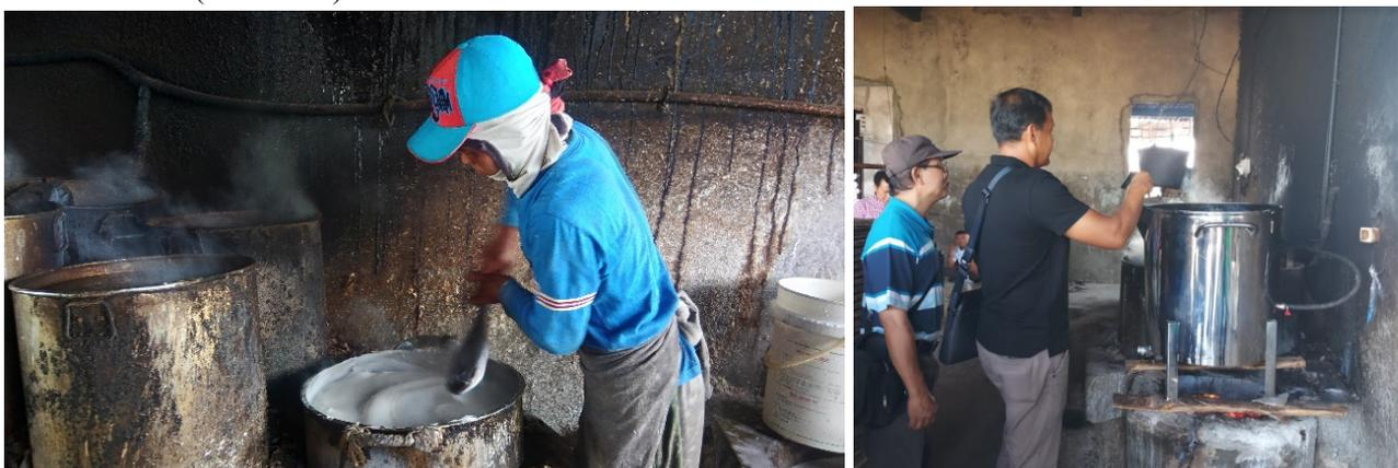
Gambar 3. Sistem pemasakan konvensional menggunakan tungku dan sistem pemasakan menggunakan *steam*
