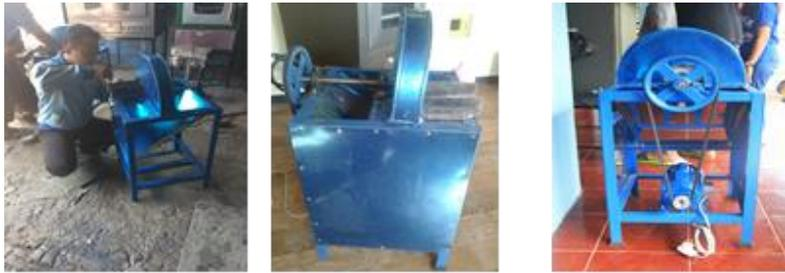
Gambar 2. Fabrikasi mesin perajang elektrik
