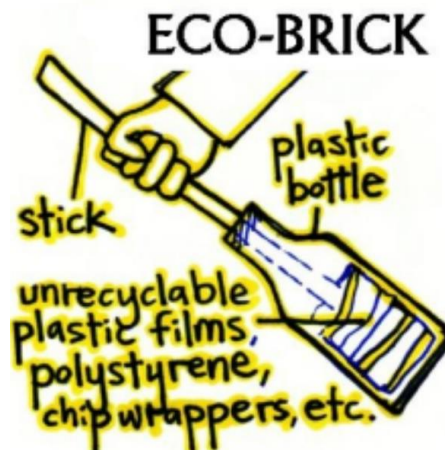
Gambar 5. Cara memasukkan dan merapatkan potongan sampah www.domarai.com/2019/03/ecobrick-solusi-menjaga-lingkungan.html
