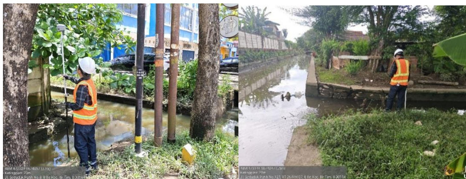
Gambar 2. Dokumentasi kegiatan pengambilan koordinat titik inventaris jaringan drainase pada beberapa segmen saluran di Jalan RW 1 RT 27 Kelurahan 8 Ilir Kota Palembang
