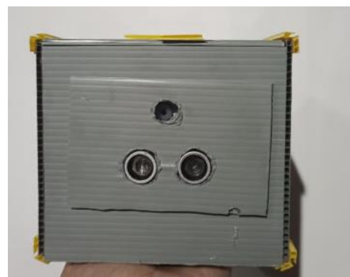
Gambar 3.10 Tampak bawah dengan sensor ultrasonik dan nozzle
