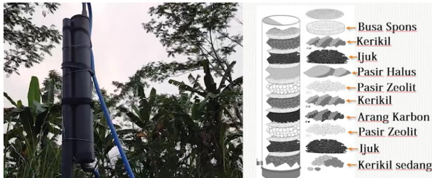
Gambar 8. Penampang urutan media saring (filter) yang direkomendasikan untuk warga RW 03 Jabungan
