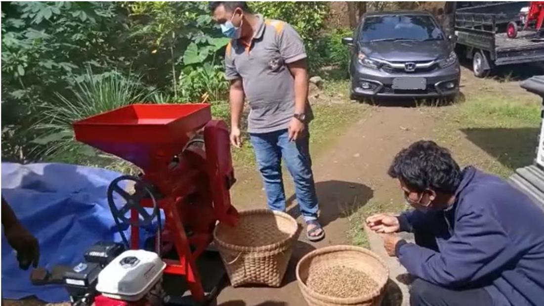
Gambar 3. Mesin *Huller* Kopi dan Proses Pengelupasan Kulit Kopi
