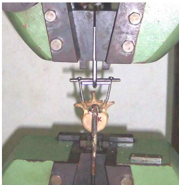
Gambar 4. Saat dilakukan uji tarik dua skrup pedikel dengan penghubung, dengan arah pada bidang sagital
