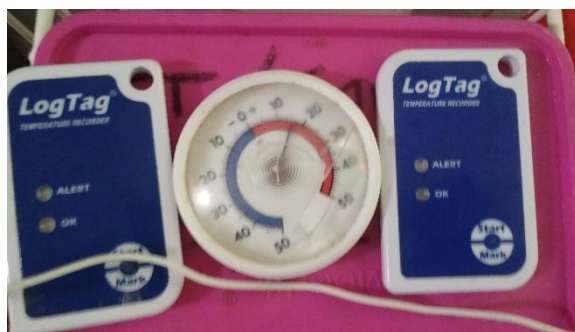
Gambar 1 Logtag (warna biru) yang tidak berfungsi. Logtag tidak menunjukkan lampu indikator menyala.
