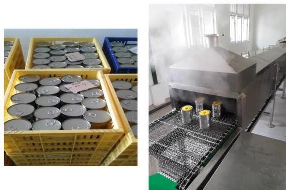
Gambar.3.Manisan Carica Kaleng dan Mesin Sterisasi Otomatic
