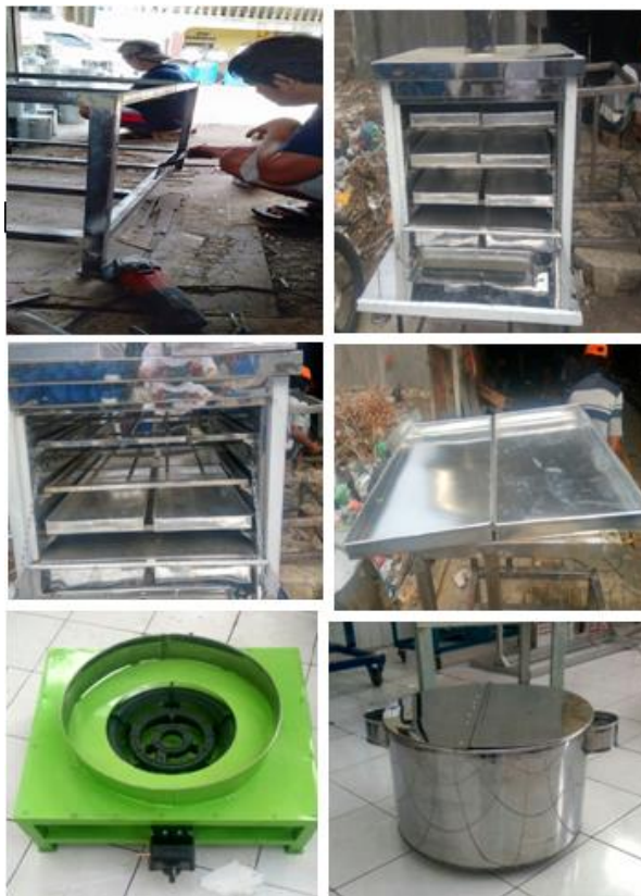
Gambar 5. Proses pabrikasi oven dan tangki pemasak
