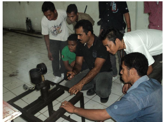
Gambar 11. Pemeriksaan tekanan injektor nosel.
