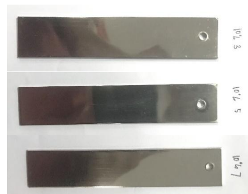
Gambar 8. Hasil uji coba pelapisan dengan proses pickling 10% HCl selama 3 menit; atas: 3 menit; tengah: 5 menit; dan bawah: 7 menit
