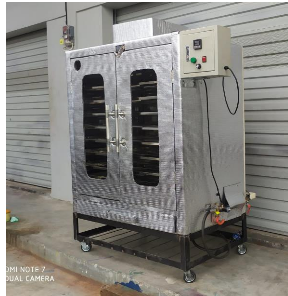
Gambar 9. Oven tipe rak hasil pengembangan Tim
