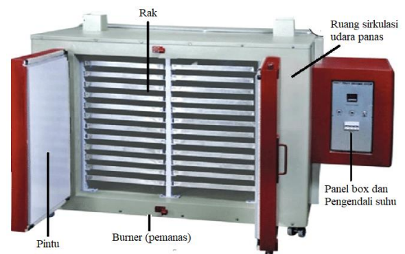
Gambar 3. Desain oven tipe rak dan pengendali suhu ruang oven
