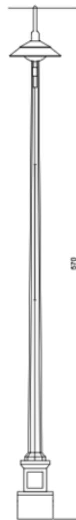
**Gambar 7.** Tampak depan tiang lampu (skala 1:40)
