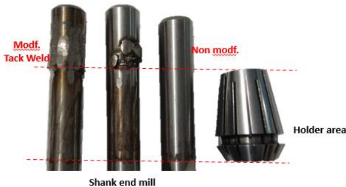
Gambar 3. Area tack weld dan kondisi holder end mill
