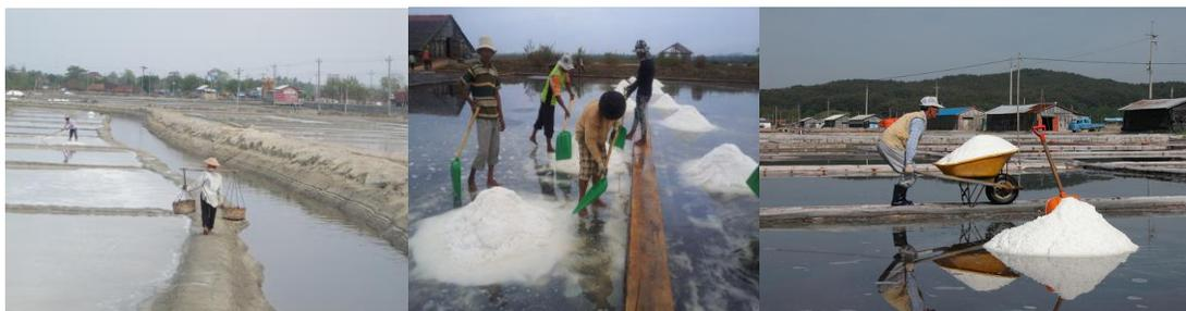
Gambar 2. Pemanenan garam pada Tambak garam dengan Teknologi Ulir Filter
