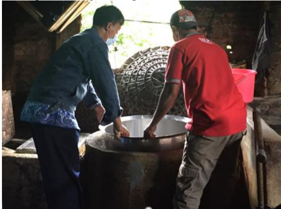
a. Pemasangan bak penggumpal
