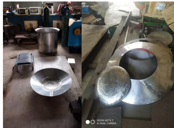
b. Proses pembuatan bagian bawah bak penggumpal
