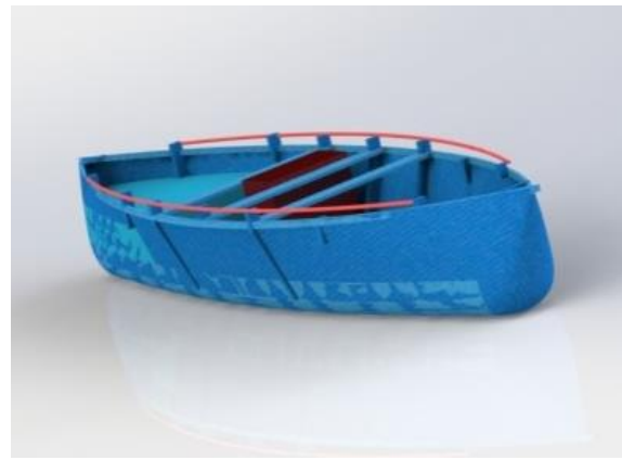
Gambar 4. Modifikasi tempat duduk dan pegangan
