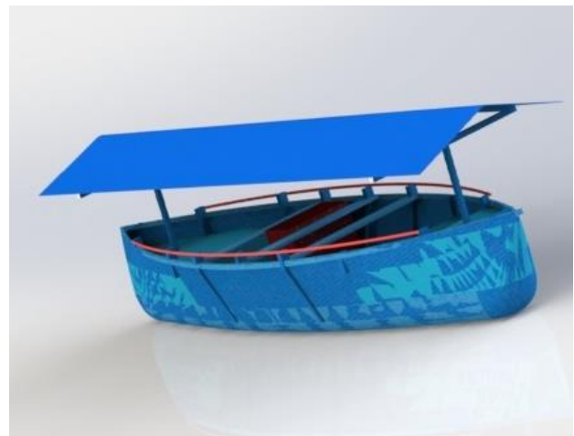
Gambar 7. Modifikasi gabungan tempat duduk, pegangan dan atap
