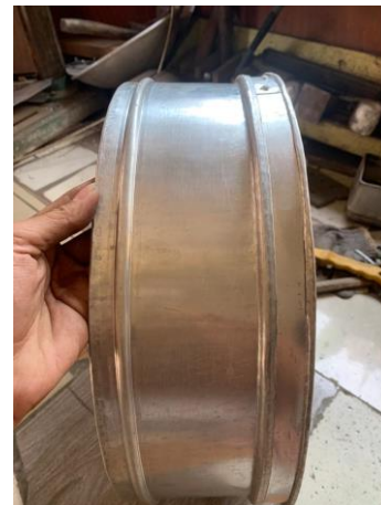
Gambar 3. Hasil proses pengerollan menggunakan mata roll 1
