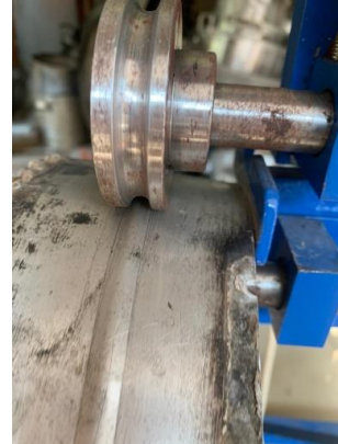
Gambar 2. Proses pengerollan menggunakan mata roll 1
