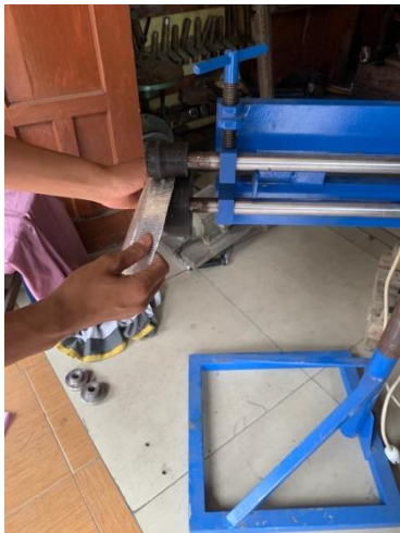
Gambar 5. Proses pengerollan menggunakan mata roll 2
