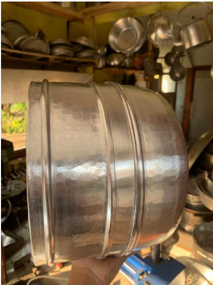
Gambar 4. Hasil pengerollan bertingkat menggunakan mata roll (1)
