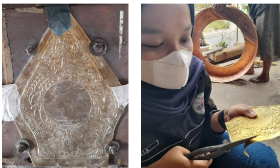
Gambar 5. Tahapan merapikan tepi prduk dan bagian tertentu
