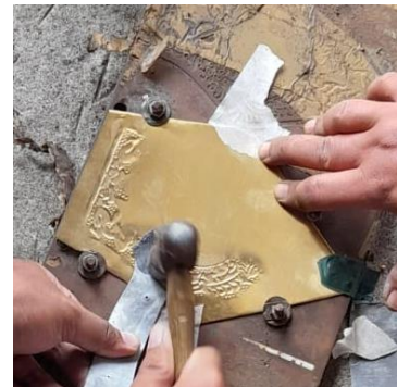
Gambar 4.b Tahapan pemukulan plat dengan palu karet
