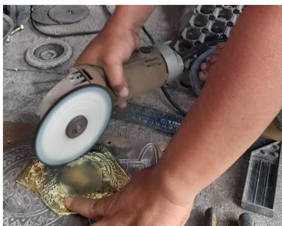
Gambar 6. Tahapan memoles produk
