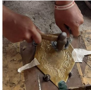
Gambar 4.a Tahapan pemukulan plat dengan palu karet
