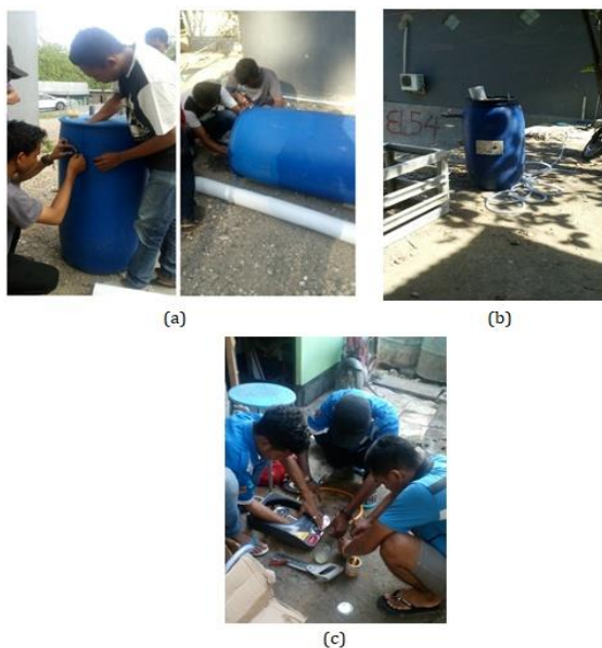
Gambar 6. (a) Pembuatan lubang pada wadah berupa drum plastik, (b) Drum plastik yang sudah dilubangi dan dipasangi pipa, (c) Perakitan kompor gas yang akan digunakan
