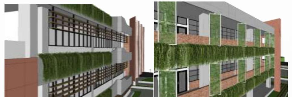
Menambahkan kantilever sebagai overhang berukuran 70-300 cm guna meredam cahaya matahari serta penambahan shading dengan material conwood dengan rangka hollow pada area fasad. Sedangkan pada area koridor menerapkan natural ventiation coridor guna menghemat penghawaan. Koridor yang terbuka memicu adanya interaksi sosial dan pandangan visual secara langsung terhadap gedung berlawanan dan inner court di area bawah.
