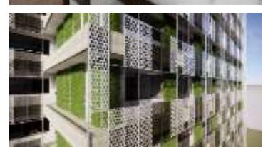
*Vertical green* sebagai *passive cooling energy*. *Perforated metal* bersifat parametrik untuk menangkal sinar UV.
