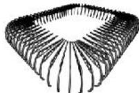
Bentuk massa stadion terbentuk dari struktur baja yang sekaligus menjadi struktur rangka atap.
