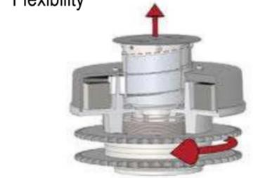
Skema batang hidrolis sistem spiralift
