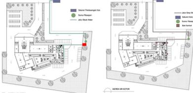
Untuk Black Water (kotoran), sistem pembuangan disalurkan menuju ke septic tank. Dari septic tank disalurkan menuju ke sumur resapan dan dikirimkan ke saluran pembuangan kota.
