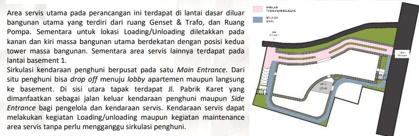
Area servis utama pada perancangan ini terdapat di lantai dasar diluar bangunan utama yang terdiri dari ruang Genset & Trafo, dan Ruang Pompa. Sementara untuk lokasi Loading/Unloading diletakkan pada kanan dan kiri massa bangunan utama berdekatan dengan posisi kedua tower massa bangunan. Sementara area servis lainnya terdapat pada lantai basement 1.
