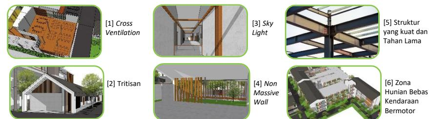
Gambar 5. Pendekatan Konsep Sustainable Design pada Desain Bangunan (Sumber: Hasil Analisis Penulis dan www.wira.co.id/baja-wf)
