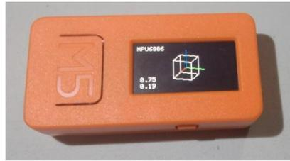
Gambar 20. Tampilan gyroscope pada modul Mstick-C
