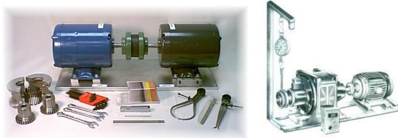
Gambar 2. Modul motor dan generator (kiri) Modul uji pembebanan motor (kanan)
