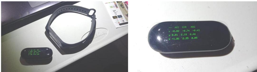
Gambar 19. Modul inti T-Wristband dilepaskan dan digunakan sebagai waterpas digital 3 dimensi
