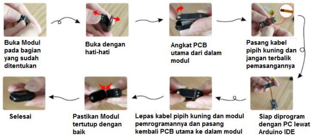
Gambar 14. Proses Membongkar Lilygo T-Wristband agar dapat diprogram
