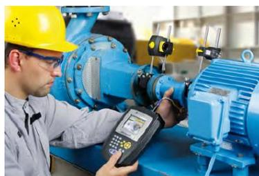
Gambar 5. Seorang operator menggunakan Modul Laser Shaft Alignment
