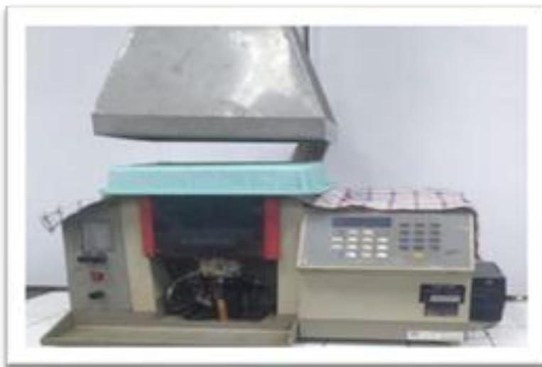
Gambar 2. Atomic Absorption Spectrophotometer (AAS) untuk pengukuran Cu
