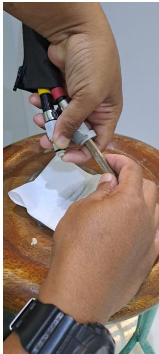
Gambar 8. Pengosongan air pada selang Tube Head
