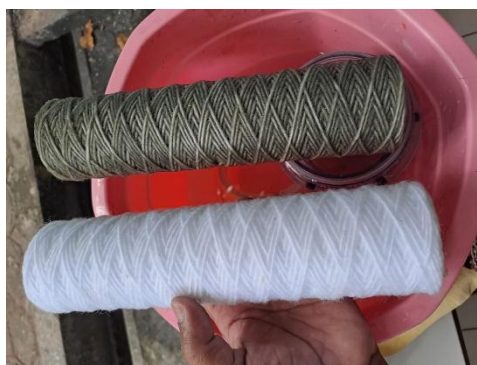
Gambar 4. Dua tipe filter air dalam sistem pendingan XRD
