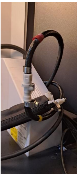
Gambar 6. Posisi Selang setelah di Baypass
