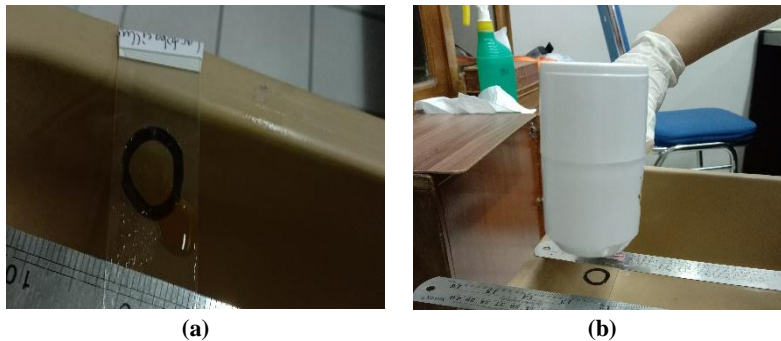
Gambar 3. Pengeringan Preparat menggunakan: (a) udara bebas dan (b) pengering rambut
