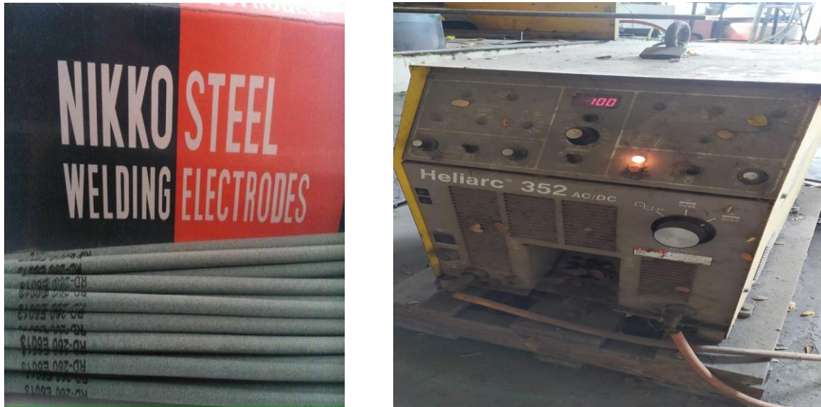
Gambar 2. Elektroda Dimeter 3,2mm & dan Mesin Las Listrik DC denga arus 100 Ampere
