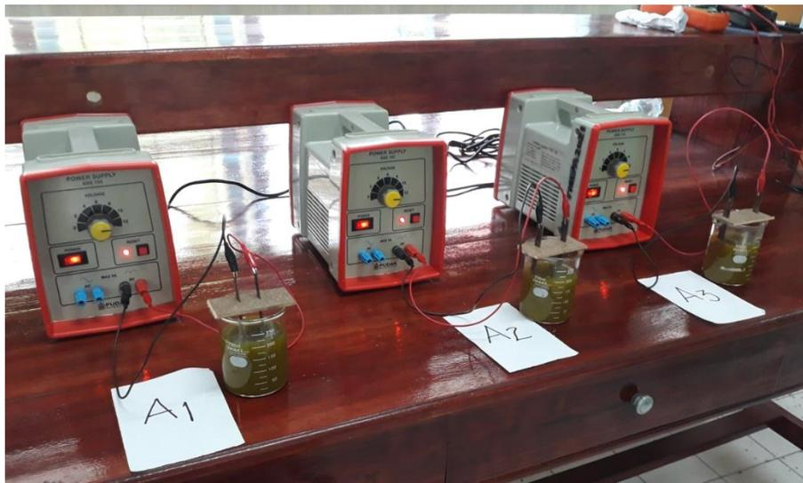
Gambar 3. Proses elektrolisis dengan variasi jarak elektroda
