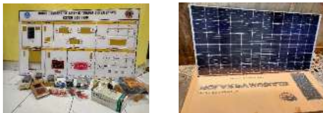
Gambar 1. Bahan/komponen electrical modul dan panel surya 320Wp
