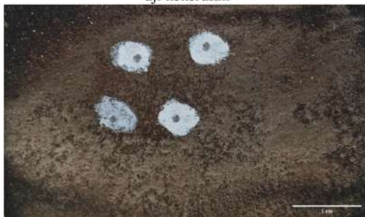
Gambar 13. Spesimen C1 dengan suhu 230°C setelah uji kekerasan
