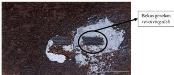
Gambar 2. Sampel A1 dengan suhu 130°C setelah uji keausan
