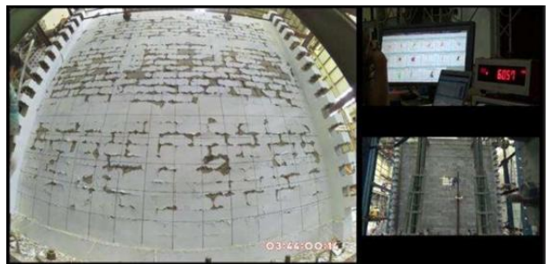
Gambar 13. Dokumentasi benda uji saat mengalami simpangan sebesar 60 mm (pembulatan)
