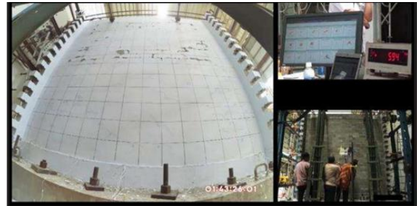
Gambar 10. Dokumentasi benda uji saat mengalami simpangan sebesar 6 mm (pembulatan)
