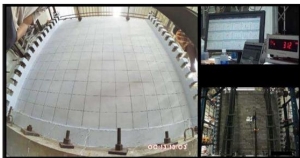
Gambar 9. Dokumentasi benda uji saat mengalami simpangan sebesar 3 mm (pembulatan)
