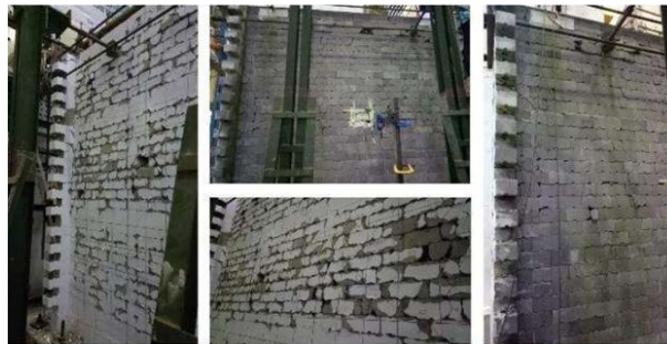
Gambar 15. Dokumentasi kondisi akhir benda uji setelah diberikan beban
