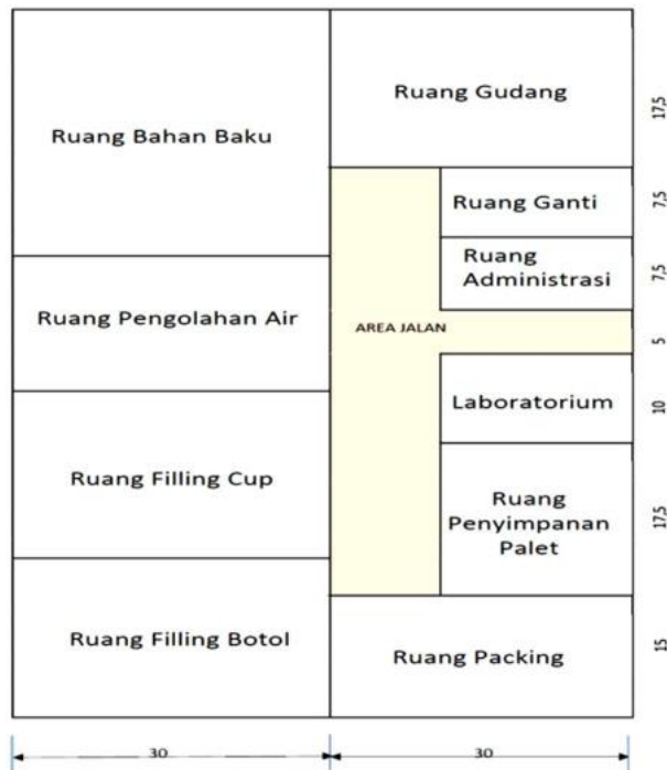
Gambar 2. Denah ruang pabrik CV Tirta Gunung Muria
