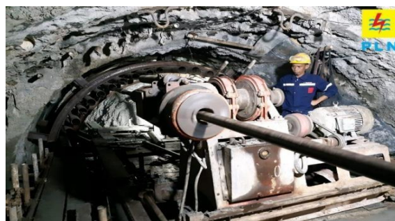
Gambar 7. Peralatan konvensional untuk grouting
