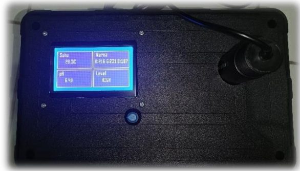
Gambar 5. Purwarupa sistem; tampilan atas
